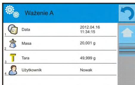
Si, en la serie ya están las muestras para los cuales hecho pesaje de la masa inicial (pesaje A), entonces se puede para estas muestras hacer el pesaje de la masa final (pesaje B).
