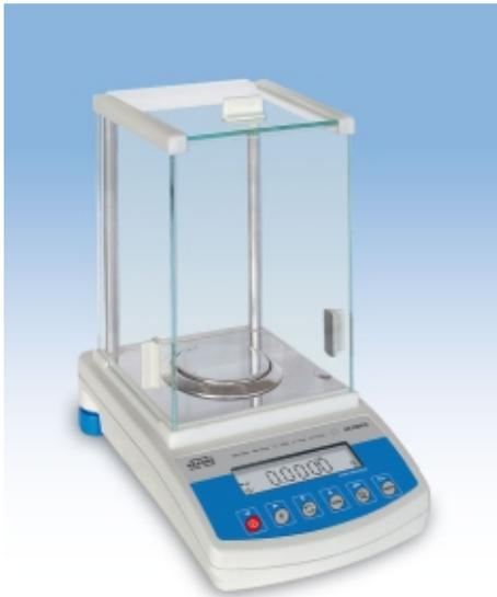
La serie AS representa el nivel estándar de balanzas analíticas. AS están equipadas de una pantalla retroiluminada de tipo LCD. La calibración automática, interna efectuada conforme cambios de temperatura y paso de tiempo garantizan la exactitud de la serie AS y la entereza de mediciones.
