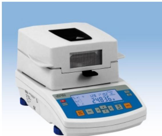
Analizador de humedad es un aparato de laboratorio aplicado a la indicación de la humedad relativa de pequeñas muestras de diferentes materiales.
