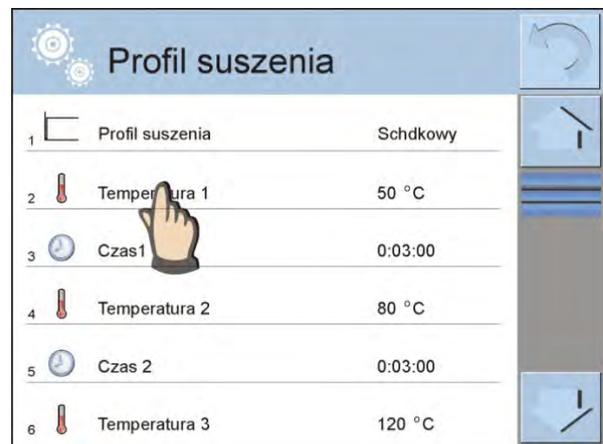
Un ejemplo de una ventana, modificar la temperatura de secado. Hay que introducir la temperatura usando el teclado numerico y confirmar.
