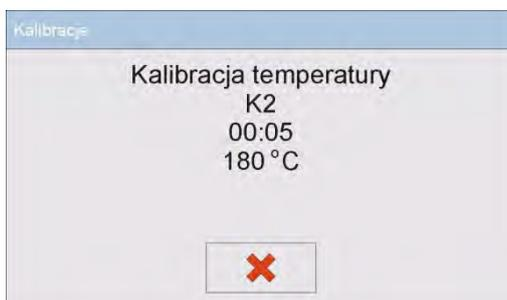
Analizador de la humedad empieza el último paso del procedimiento, calentar la cámara para la temperatura más y durante los siguientes minutos mantener la temperatura de cámara mostrando su estado actual.
