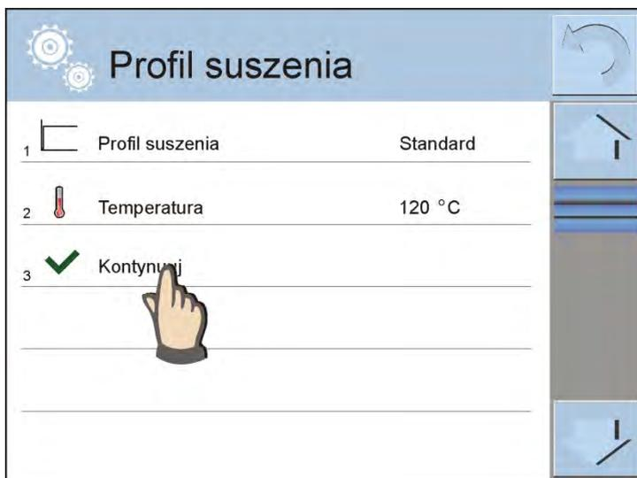
Se muestra la ventana, en la cual hay que seleccionar el perfil del secado para el cual se puede comprobar la temperatura y ajustar el parametro del perfil: temperatura, tiempo (dependiente de perfil). Luego pulsando el campo <Continuar> hay que pasar al siguiente punto del procedimiento.
