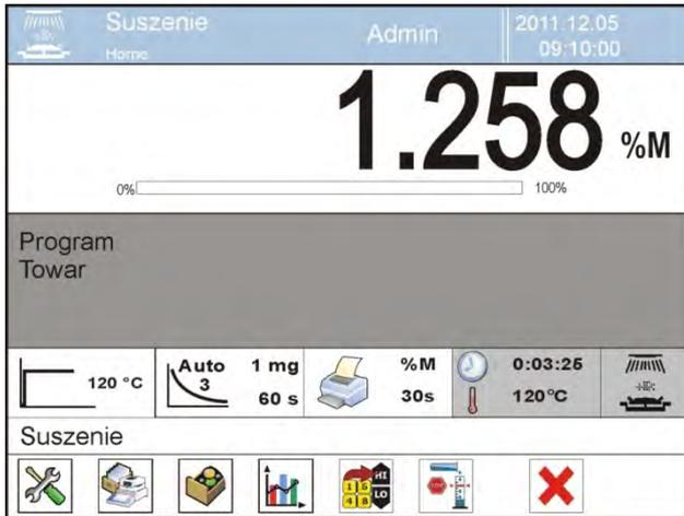
Durante el secado en la pantalla se muestra el resultado de mediada actual y las informaciones sobre el mismo proceso (tiempo de la prueba, temperatura de camara etc.).
