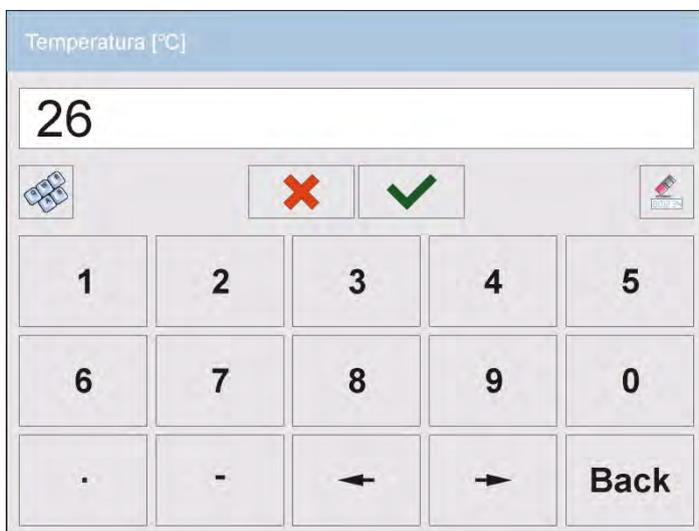
Después de 8 minutos,, en la pantalla se muestra la ventana con el teclado numerico.Hay que introducir el valor adecuada a la temperatura del analizador de la humedad, que se debe leer con un termómetro externo. Utilizando el botón <CONFIRMAR >,hay que iniciar la próxima parte de la calibración.
