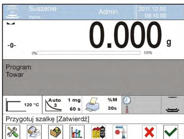
El programa muestra el mensaje , que el usuario preparó el platillo. Hay que colocar el platillo desechable en el mango y ajustarlo en cruceta.
