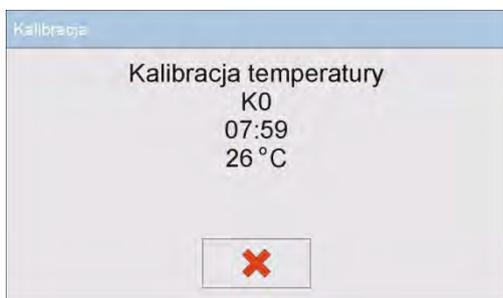
Analizador de la humedad muestra un mensaje para iniciar el procedimiento y la información sobre el proceso (número de paso, temperatura, tiempo de calentamiento).
