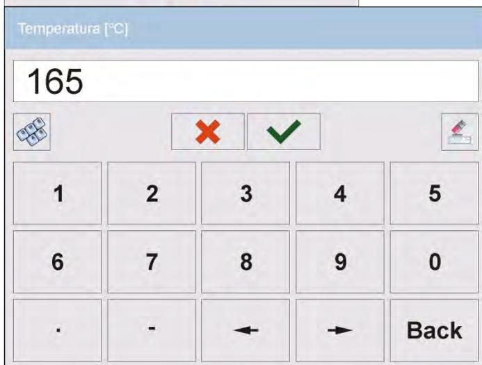
Después de este tiempo, en la pantalla se muestra la ventana con el teclado numérico. Hay que introducir el valor correspondiente a la temperatura actual del analizador de la humedad, como leer del termómetro externo. Usando el botón <CONFIRMAR> hay que terminar el procedimiento.
