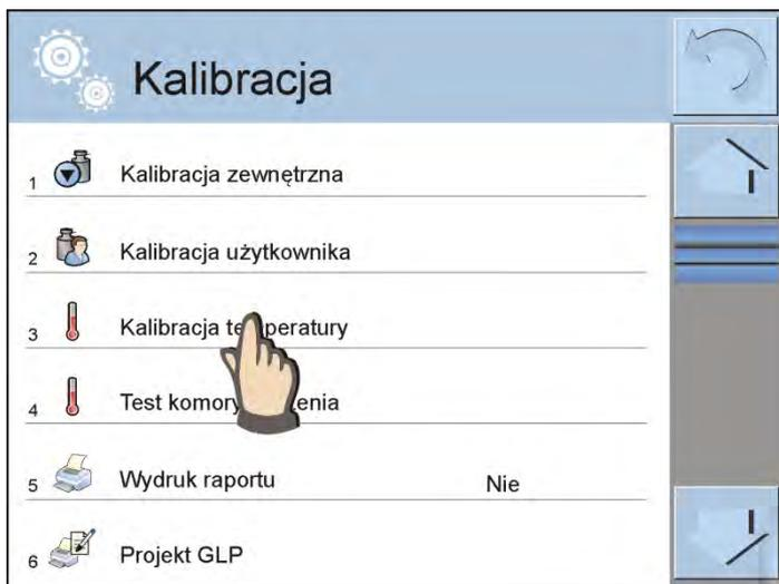
Entrar en el grupo del menú <Calibración>. Iniciar el proceso pulsando el nombre del procedimiento <Calibración de la temperatura>
