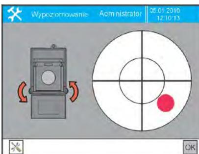
La pantalla de balanza presentará el panel de control de la función de nivelación. Al lado de la vista del nivel, se presentará la vista de balanza con flechas direccionales pulsantes, definiendo la manera de dar vueltas de las patas de balanza, para su nivelación. La vista de balanza depende de su tipo.
