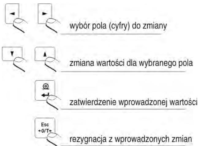
Imagen.12. Teclas de balanza - introducción los valores en el menú
