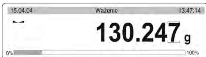
Imagen . 9. la balanza de dos límites – resultado de pesaje en I límite
